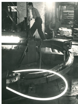
Interiör från stångjärnsverket Södra verken 1962. Valsning av armeringsjärn. Foto Bo Dahlin 1962
