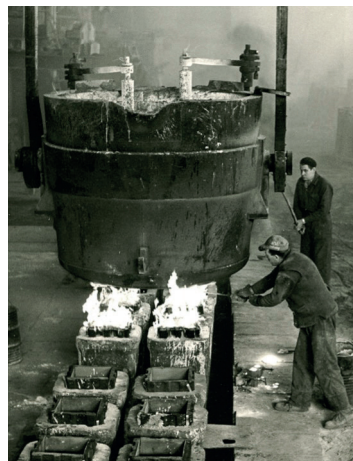
Interiör från stålverket. Tappning från skänk i kokiller. Foto K W Gullers ca 1955
