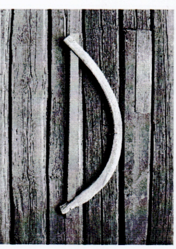
Gammal bågsgåg med blad infäst i självväxt gren
