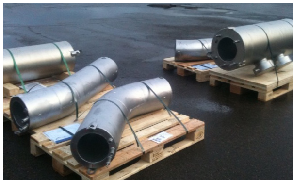
HIP-produkter för offshore från Bodycote i Surahammar före slutlig värmebehandling
