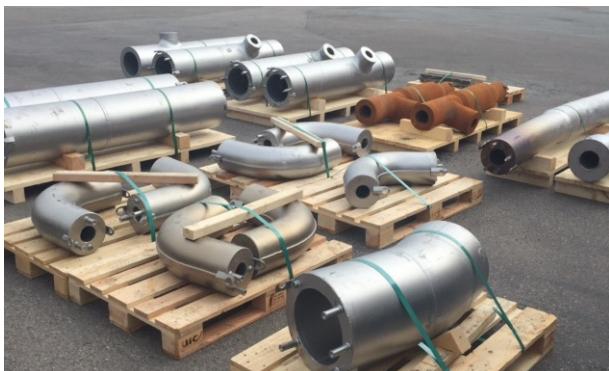
HIP-produkter för offshore från Bodycote i Surahammar före slutlig värmebehandling
