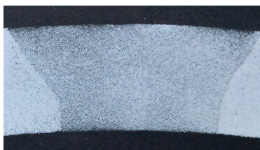
Helt rekristalliserad svets på stångdraget rör efter blankglödning
